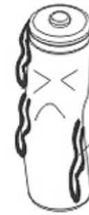
Battery leakage 電池漏液
